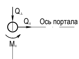
Схема нагрузок на фундамент
