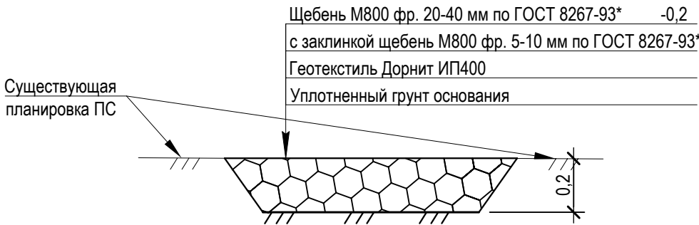
Конструкция щебеночного покрытия Тип 1. М 1:20
